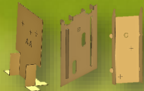
Bohrschablonen drilling jigs
